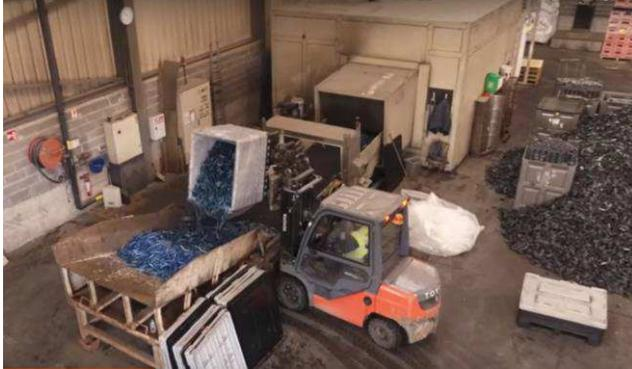
Broyeur à lames Bruno Folcieri de 250kW de puissance équipé d'un tapis d'alimentation avec détecteur de métaux S+S. Les lames du broyeur ont 50 h après affûtage (en moyenne, un affûtage est réalisé toutes les 75 h de fonctionnement).
