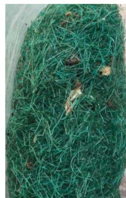
On constate à la sortie du broyeur un polyamide bien densifié et qui, malgré certaines craintes, ne semble pas foisonner<sup>2</sup>. Sur un essai industriel, il sera ainsi possible de remplir des bigbags d'une tonne de matière. La matière est bien sèche et on remarque peu de perte de plastique entre la quantité en entrée et en sortie. La grille de 14mm semble être adaptée au filet de pêche en pelote. Les indésirables de matière organique polluent la matière : aspect et odeur.
