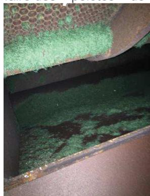
Une demi-heure est nécessaire pour broyer environ 120Kg de filets en pelote et mettre en bigbag 95Kg. Deux opérateurs sont requis pour cette opération : un opérateur au grappin et un au broyeur qui doit être en mesure d'arrêter la ligne de broyage dès le moindre problème.
